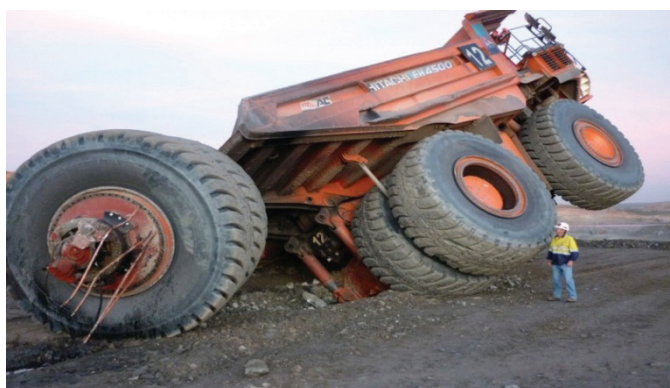
Slika broj 4: Otkaz na kamionu sa katastrofalnim posledicama
